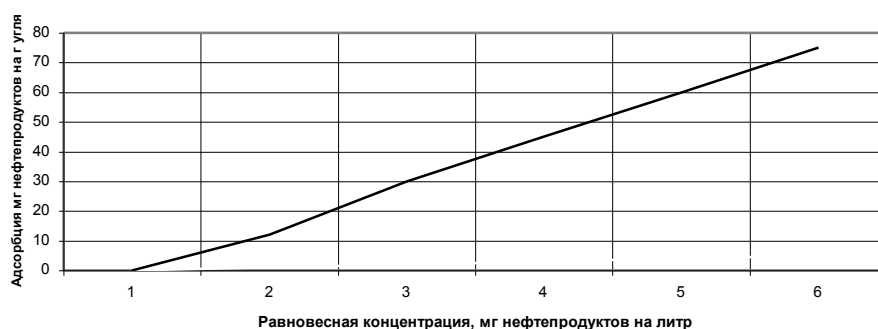
Рисунок 1. Изотерма адсорбции углем нефтяных загрязнений.
