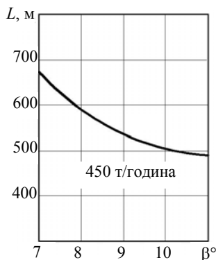
Рисунок 12.7. Залежність довжини транспортування від експлуатаційної продуктивності і кута нахилу виробки для конвеєра 2Л100У
