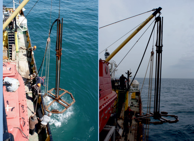
Установка УМБ-130 при проведении инженерно-геологических изысканий на трассе трубопровода Джугба–Лазаревское–Сочи, 2008 г.
