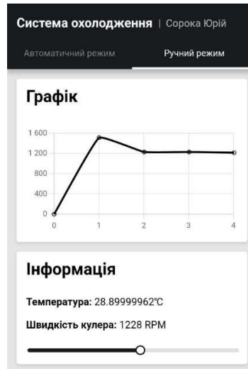
Рисунок 5 – Тестування системи у ручному режимі роботи
