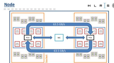
Рисунок 2. Схема вузла архітектури HPE Apollo 9000 Hawk
