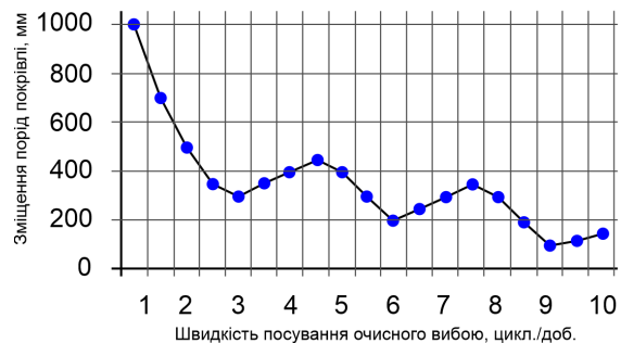
Рис. 5. Графік залежності зміщень покрівлі в лаві від швидкості посування очисного вибою [4]
