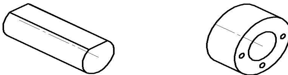
Рисунок 7.26 – Приклади конструкції деталей, які відносяться до III класу за складністю орієнтування
