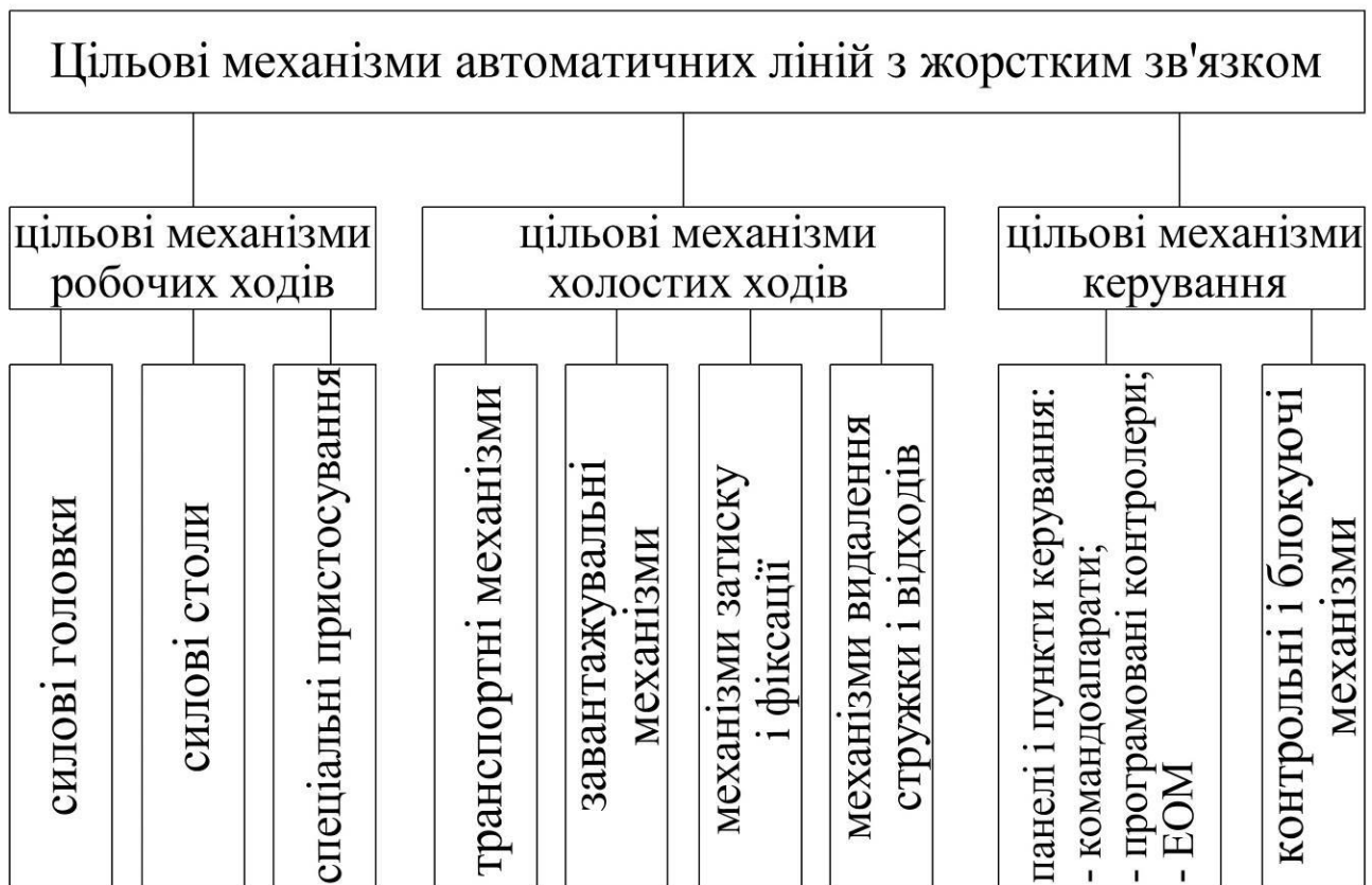
Рисунок 7.1 – Основні типи цільових механізмів автоматичних ліній
