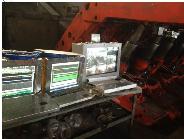
Рис. 7. Основне обладнання супроводу автоматичного виймання: (а) система відеоспостереження в лаві; (б) система дистанційного керування комбайном [23]
