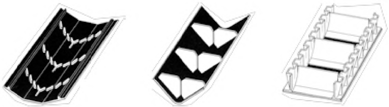
Рисунок 1.4 – Приклади стрічок для крутих кутів транспортування
