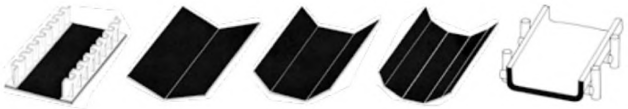
Рисунок 1.2 – Форма стрічки в залежності від типу роликоопор (зліва направо): плоска стрічка, жолобоподібна стрічка з V-подібним жолобом, жолобоподібна стрічка з 3-роликів жолобом, жолобоподібна стрічка з 5-частинним жолобом, стрічка з квадратним жолобом
