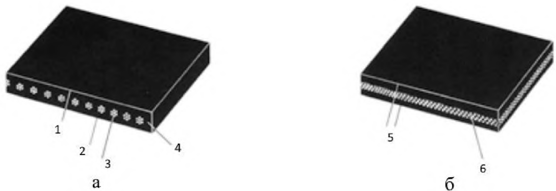
Рисунок 1.3 – Будова конвеєрної стрічки:
