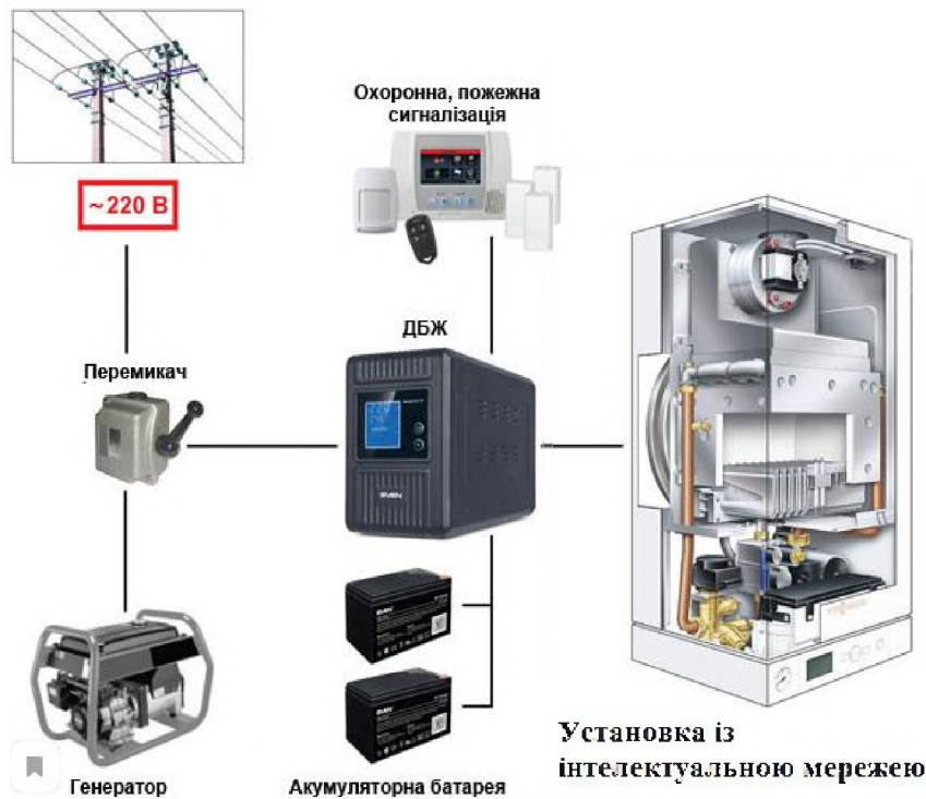
Рисунок Б.3 – Структурна схема мережі безперебійного живлення
