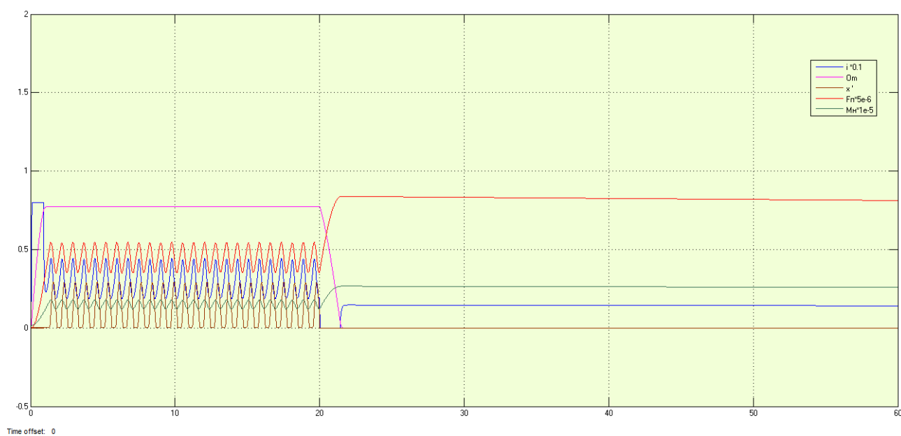
Рисунок 3.5 – Стопоріння комбайна в режимі холостого ходу при довжині тягового ланцюга 100 м з захистом привода при швидкості подачі 7 м/хв
