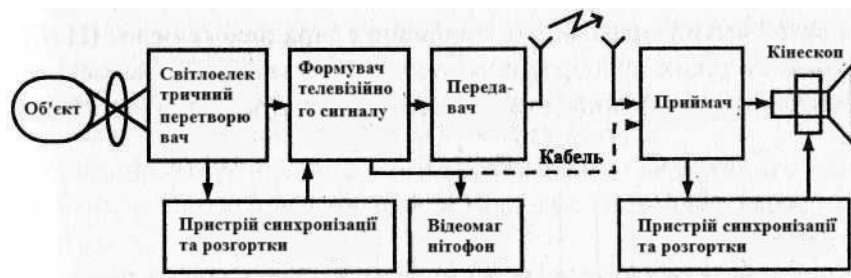
Рисунок 7.1 – Схема комплексу засобів телебачення
