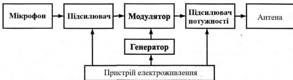
Рисунок 8.2 – Схема акустичної закладки
