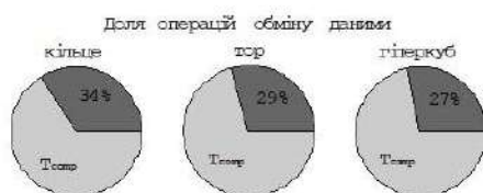
Рисунок 4 – Доля операцій обміну даними в загальному часі виконання ВПНМ для різних топологій з'єднання процесорів при розподіленій пам'яті
