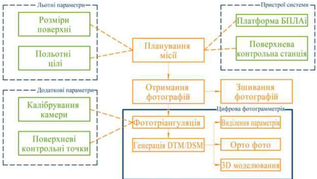
Рисунок 4.1. - Процес отримання та обробки зображень БПЛА при фотограмметричних дослідженнях
