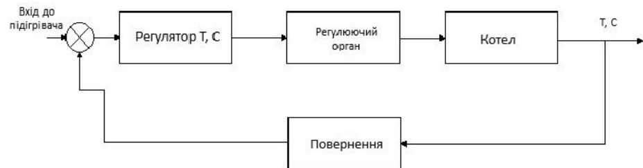
Рисунок 1 – Схема регулювання води на виході з котла
