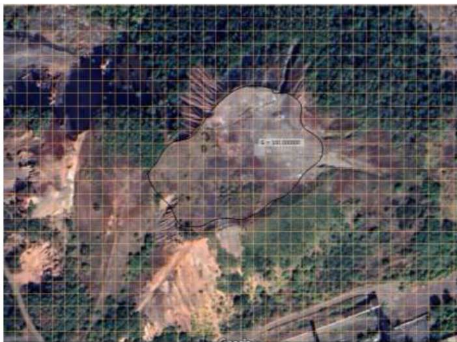
Рисунок 3.1. Приклад оцифровки терикону шахти Центральна
