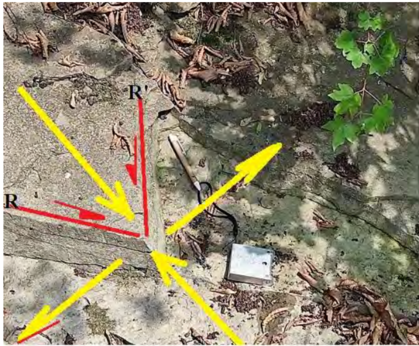
Рисунок 3.2. - Приклад визначення напрямків стиснення та розтягнення в туфах дялянки № 1 по парагенезису R та R'-сколів
