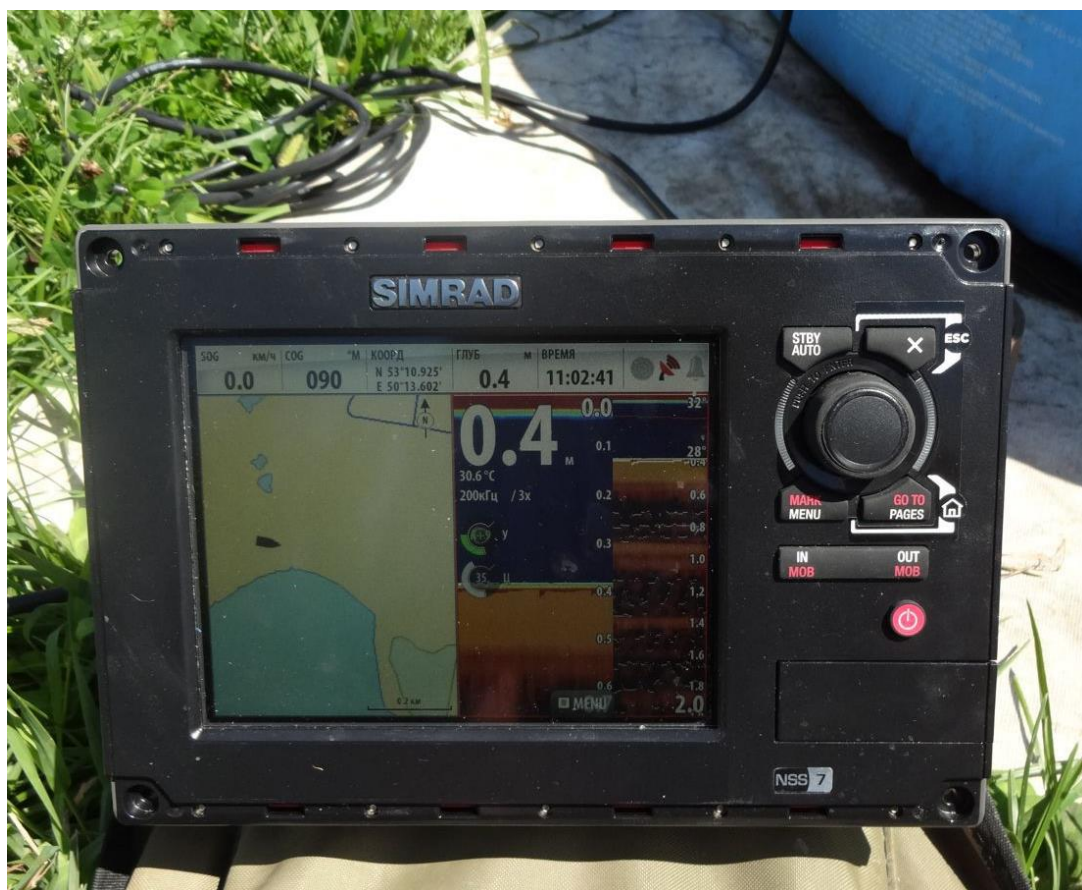
Рисунок 2.1.8 – Батиметричне знімання приладом ехолот з GPS-навігацією SIMRAD NSS7
