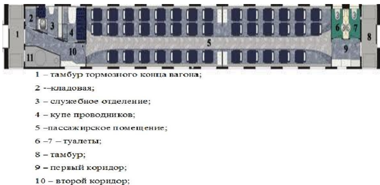
Рис.1.6 – Приміщення вагона (відповідно до планування)
