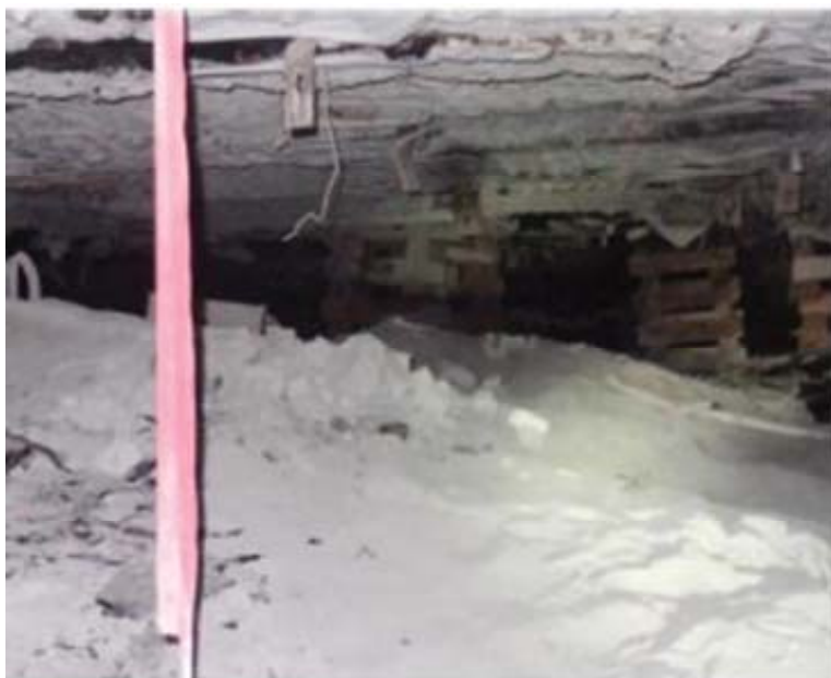
Рисунок 1.5 – Підняття підшви на вугільній шахті West Kentucky [7]
