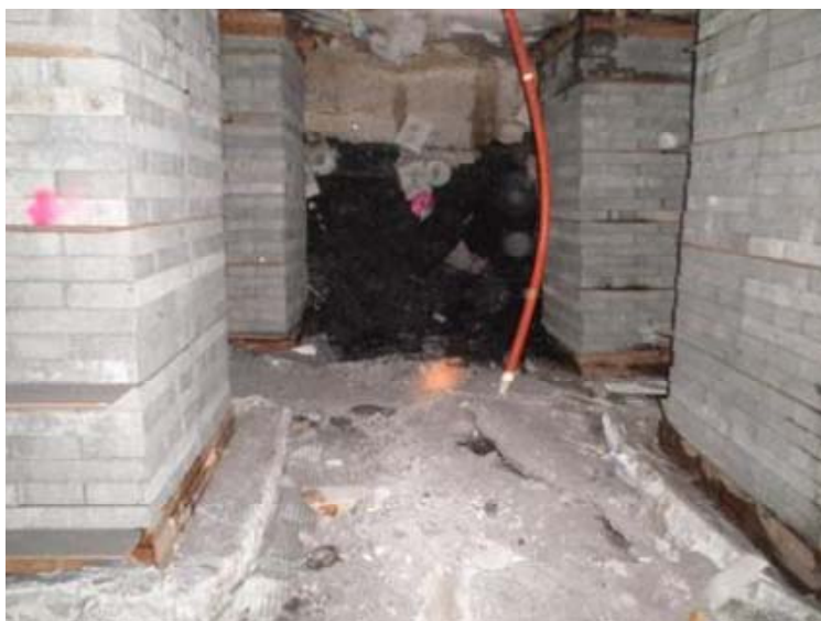
Рисунок 1.6 – Вдавлення охоронної смуги в підшву на Crinum mine in Queensland [13]
