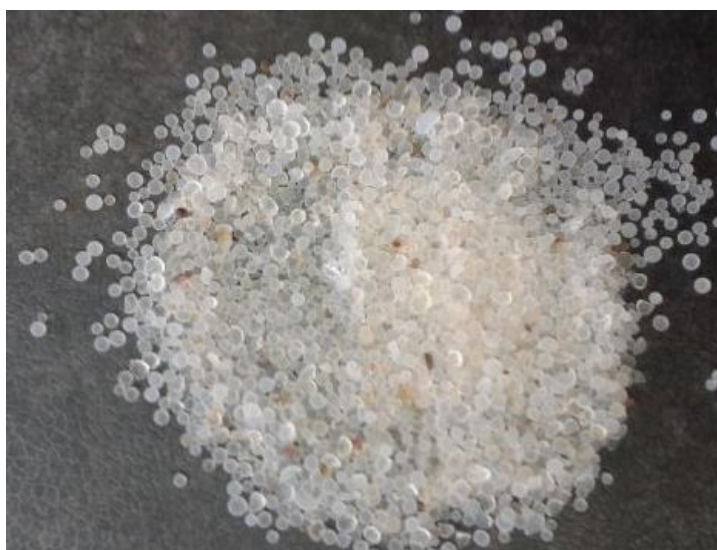
Рисунок 4.5 – Зовнішній вигляд силікагелю марки КСКГ після регенерації
