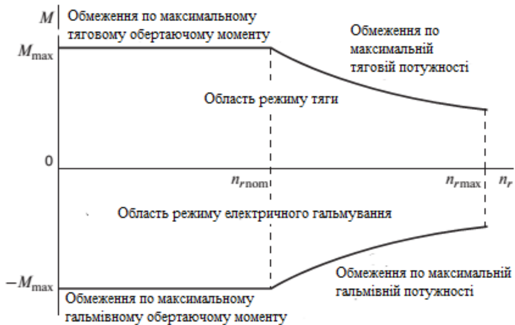
Рисунок 2.11 – Робоча область ТАЕД за умови його частотного керування
