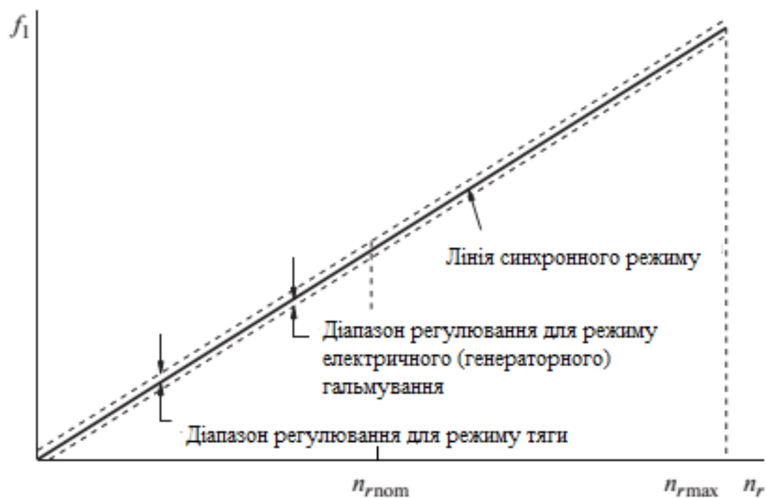
Рисунок 2.11 – Зображення функції регулювання значення частоти фазної напруги f_1 від частоти обертання ротора n_r за умови частотного керування ТАЕД
