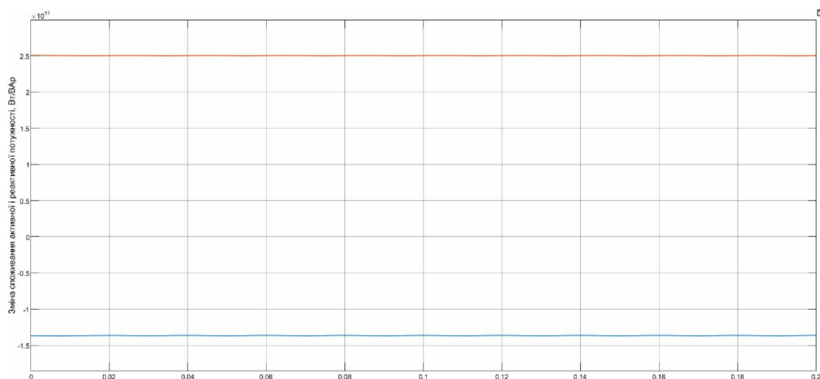
Зміна споживання активної і реактивної потужності на холостому ході
