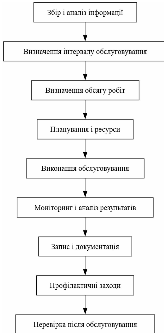
Рисунок 2.13 – Послідовність прогностного технічного обслуговування силового вимикача
