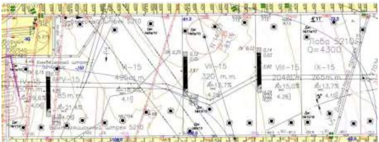
Рис. 2.18 – Викопування із плану гірничих робіт на ділянці з розташуванням дегазаційних свердловин
