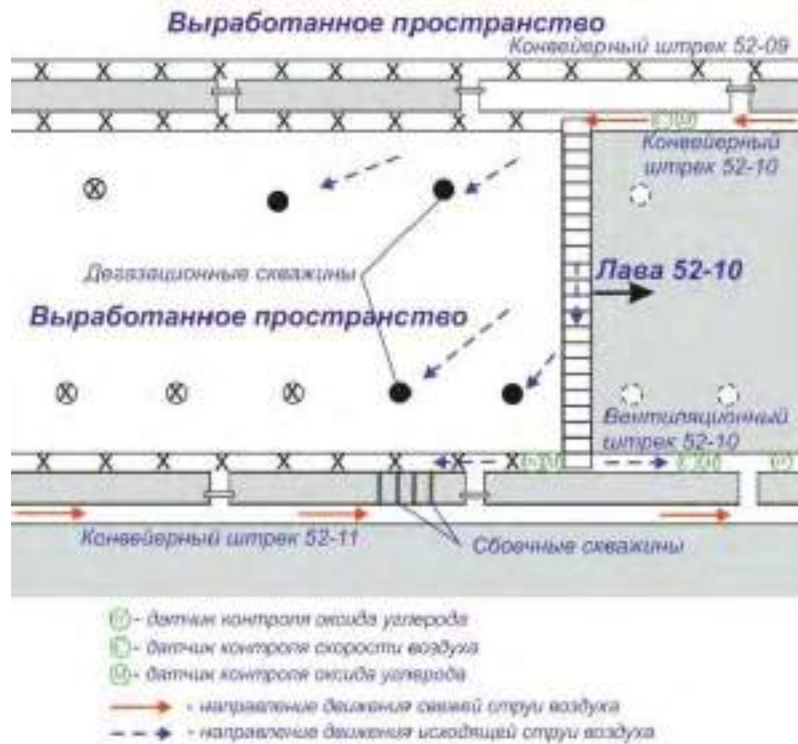
Рис. 2.1 – Схема керування газовиділенням на виїмковій ділянці
