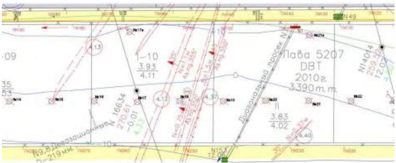
Рис. 2.26 – Викопування з плану гірничих робіт на ділянці високої геологічної порушеності з розташуванням дегазаційних свердловин
