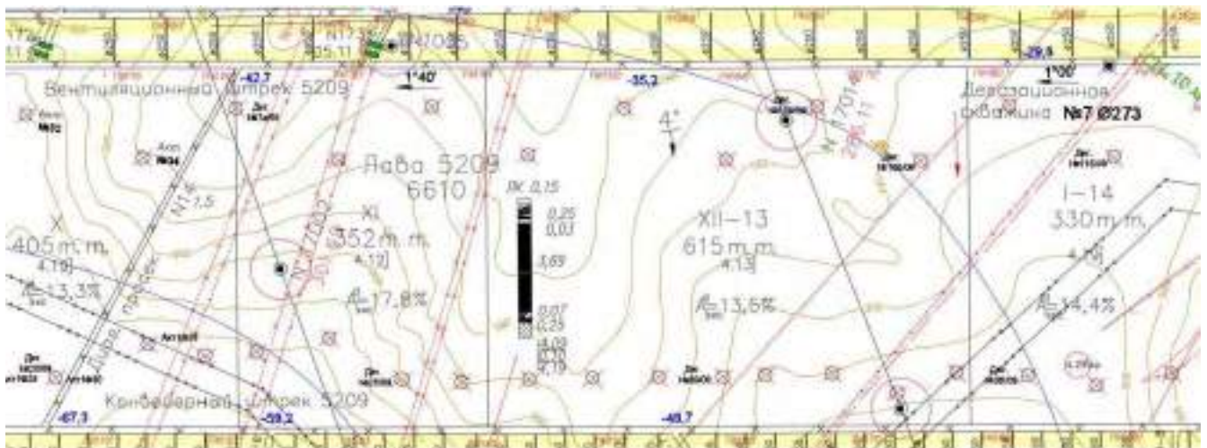
Рис 2.15 – Викопування з плану гірничих робіт на ділянці шахти з розташуванням дегазаційних свердловин
