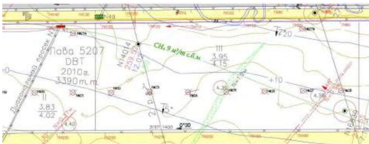
Рис. 2.12 – Викопування з плану гірничих робіт на ділянці з розташуванням дегазаційних свердловин
