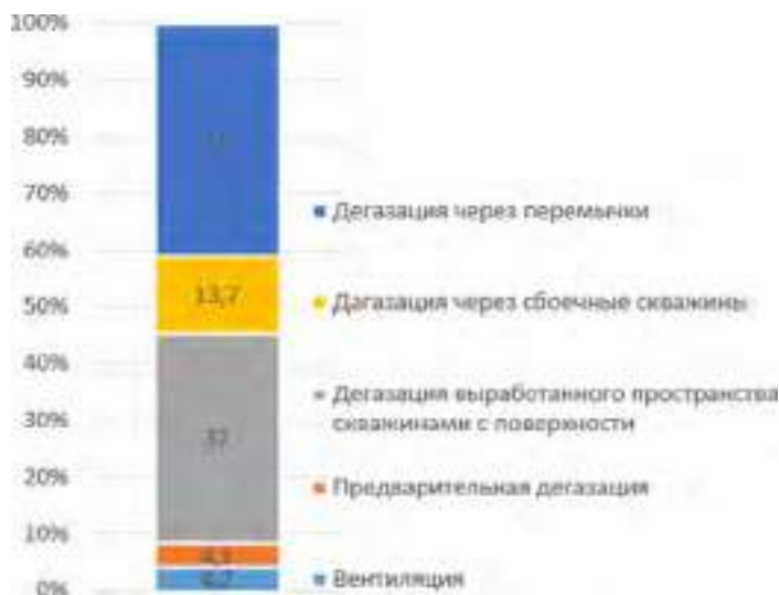
Рис. 1.18 – Структура газового балансу виїмкової ділянки
