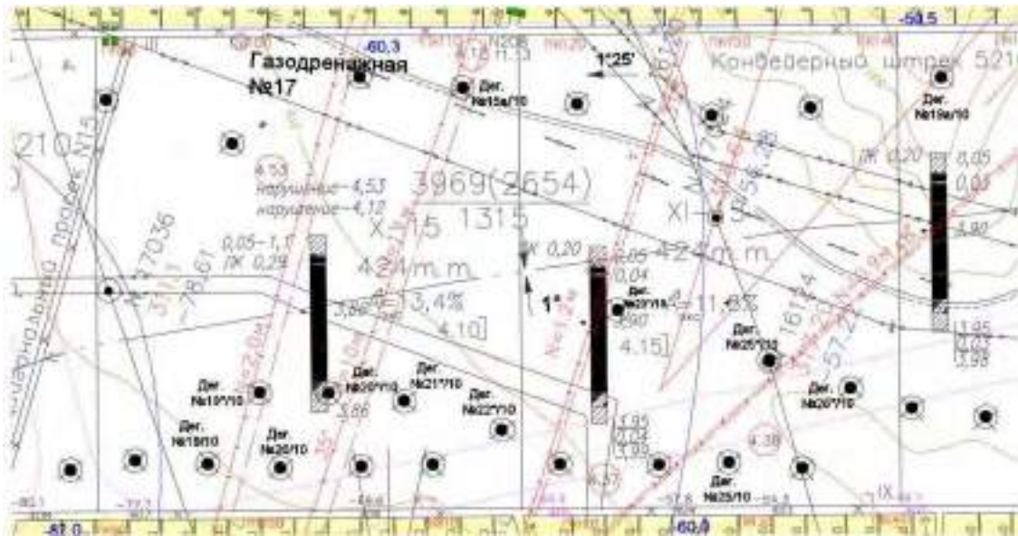
Рис. 2.24 – Викопування з плану гірничих робіт на ділянці високої геологічної порушеності з розташуванням дегазаційних свердловин
