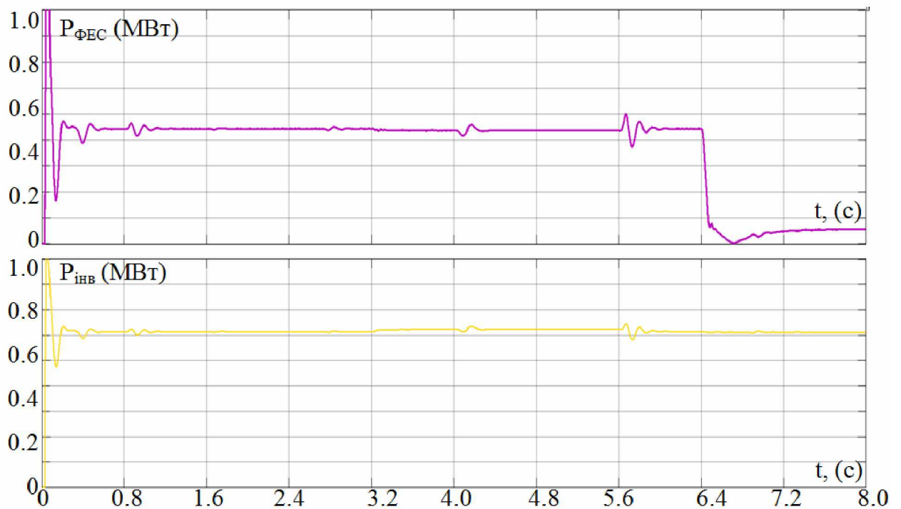
Рисунок 4.15 – Потужність, що надходить від ФЕС та виміряна на виході інвертору
