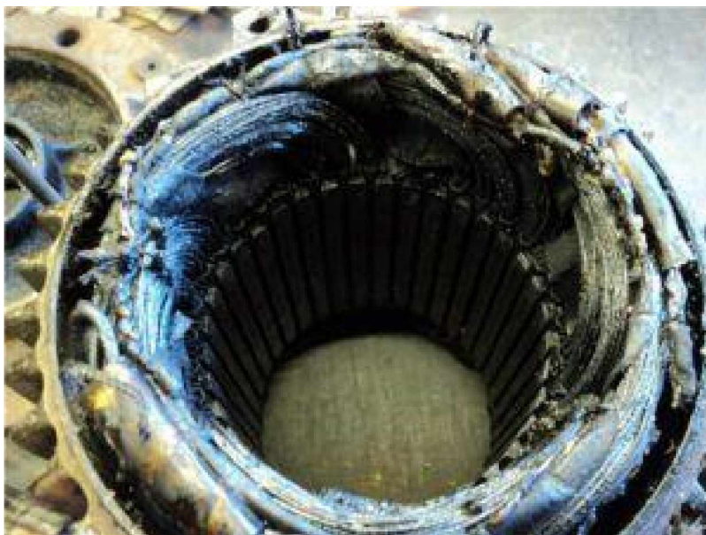
Фото згорілих статорних обмоток асинхронного електродвигуна
