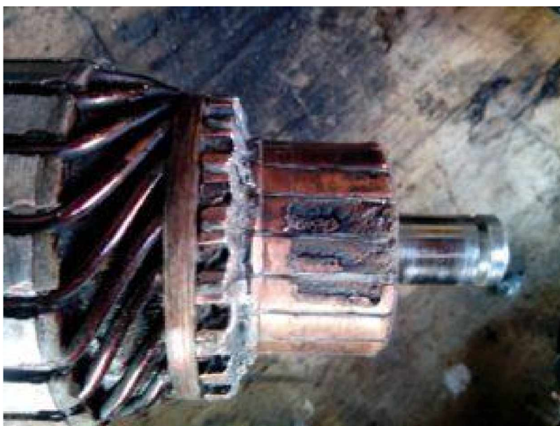
Фото пошкоджених колекторних контактних пластин фазного ротора асинхронного двигуна
