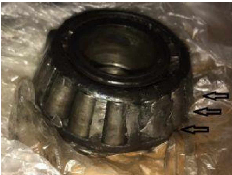
Фото частини валиків кочення підшипника асинхронного двигуна
