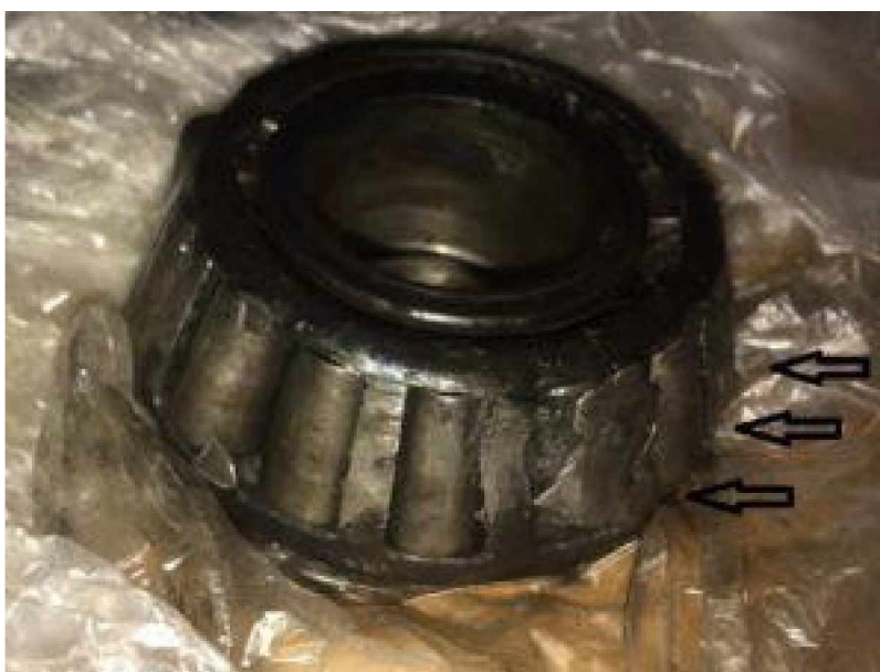
Рисунок 1.3 – Фото частини валиків кочення підшипника асинхронного двигуна [4]
