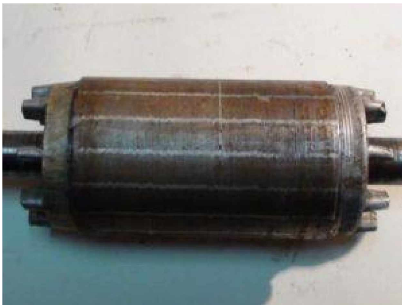
Рисунок 1.5 – Фото поверхні магнітопроводу короткозамкненого ротора асинхронного двигуна [4]
