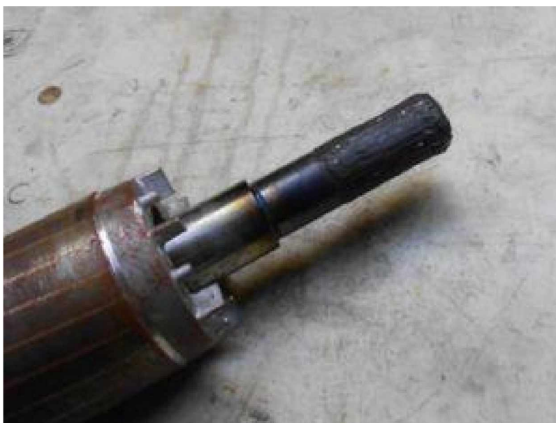
Рисунок 1.2 – Фото зношеного і деформованого короткозамкненого ротора асинхронного двигуна [4]
