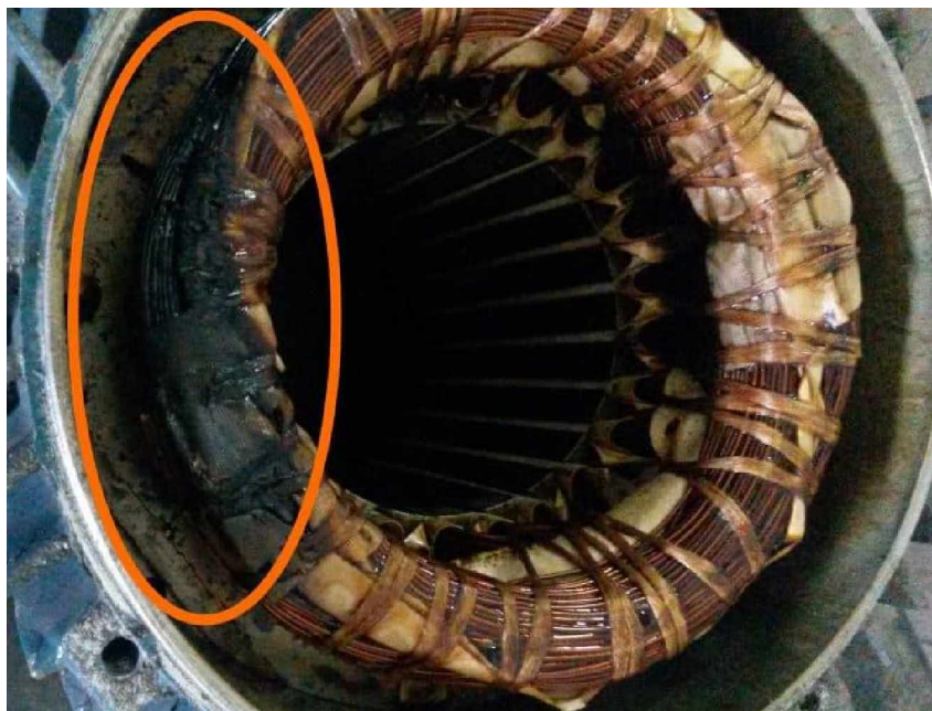
Рисунок 1.7 – Фото міжвиткових коротких замикань у статорній обмотці асинхронного двигуна [5]
