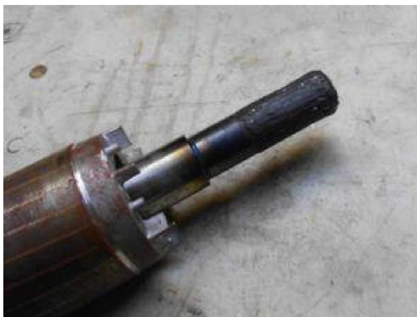
Фото зношеного і деформованого короткозамкненого ротора асинхронного двигуна
