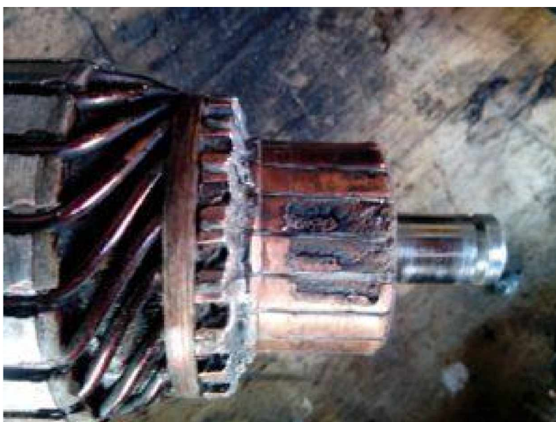
Рисунок 1.4 – Фото пошкоджених колекторних контактних пластин фазного ротора асинхронного двигуна [4]
