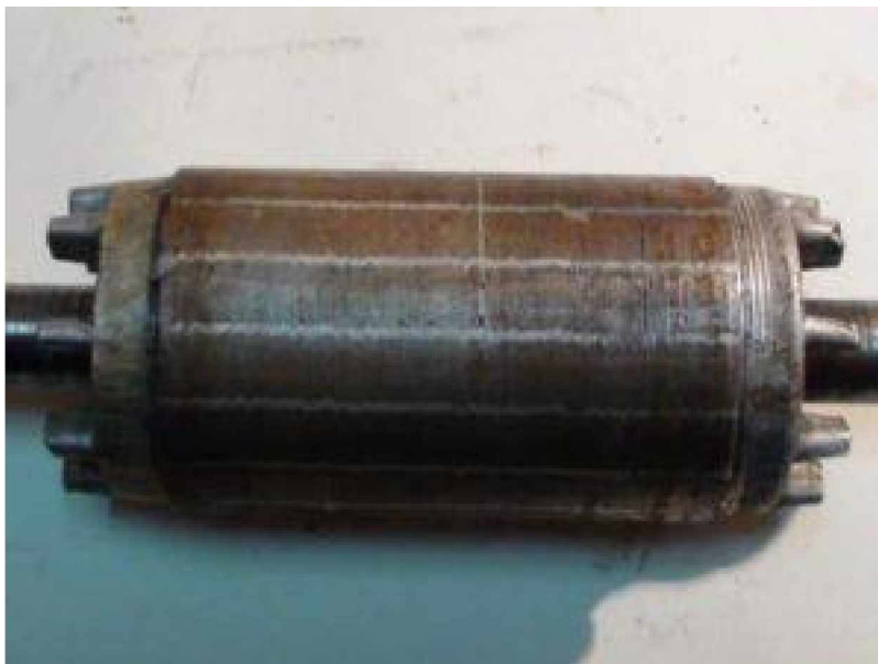
Фото поверхні магнітопроводу короткозамкненого ротора асинхронного двигуна
