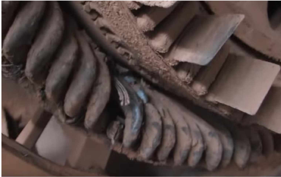
Рисунок 1.8 – Фото критичного ушкодження статорної обмотки асинхронного двигуна [5]
