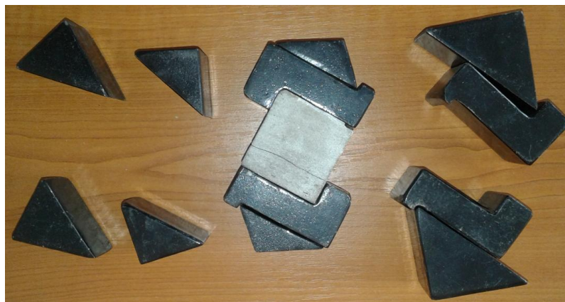
Рисунок 2.9 – Металеві матриці з кутом нахилу 15^\circ , 30^\circ та 45^\circ .
