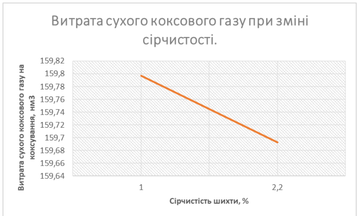
Рисунок 3.11 – Залежність витрати сухого коксового газу на коксування 1000 кг вологої шихти від її сірчистості на суху масу
