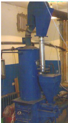
Рисунок 4.2 Фото експериментального стенду топкового блоку із процесом шарового спалювання вугілля
