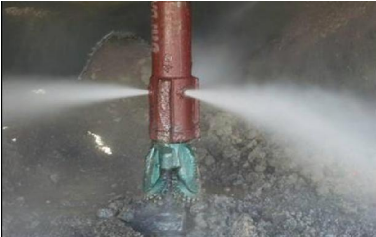
Рисунок 5.2. – Водовідділювач, який не дозволяє воді потрапляти на наконечник буру
