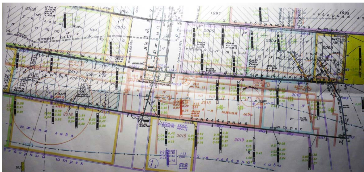
Рисунок 2.1 Вико́пювання з плану гірничих виробок в районі 5 південної і північної лав в блоці 3 по пласту I_3
