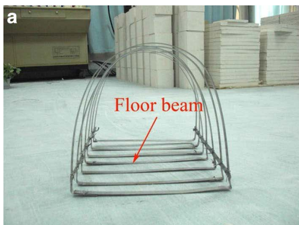
Рисунок 4.12 – Фізична модель для дослідження процесу підняття підлоги а) загальний вигляд моделі; б) кріплення; в) вид кріплення в моделі
