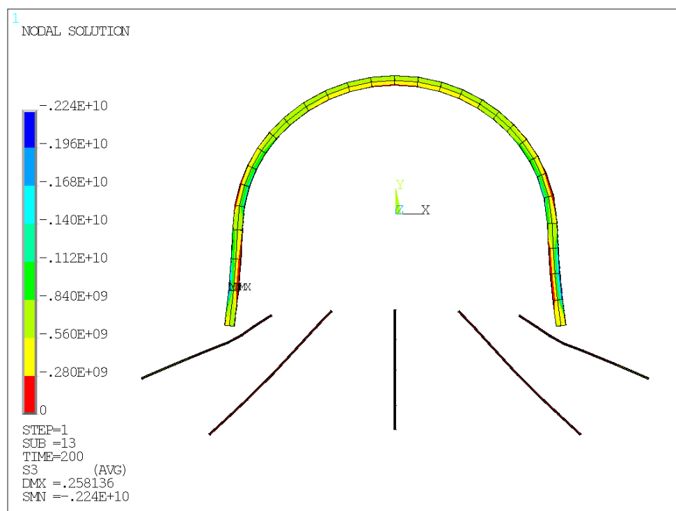
Рисунок 6.5 – Загальний вигляд системи кріплення при кріпленні підосви сталевими полімерними анкерами довжиною 2,0м
