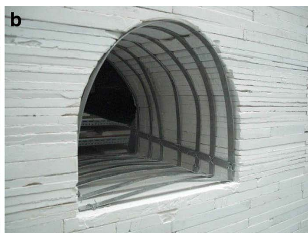
Рисунок 4.12 – Фізична модель для дослідження процесу підняття підлоги а) загальний вигляд моделі; б) кріплення; в) вид кріплення в моделі
