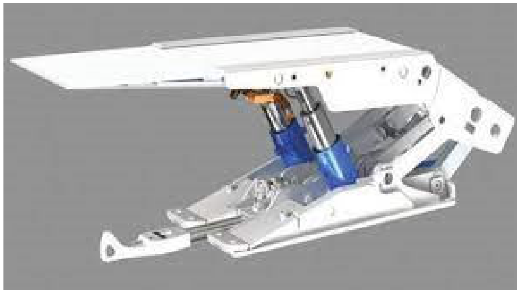
Рисунок 2.3 – Загальний вигляд секції механізованого кріплення КДД
