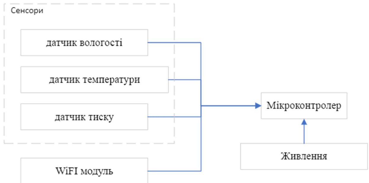
Рисунок 2.1 – Функціональна схема автоматизованої метеостанції з мікроконтролерним керуванням
