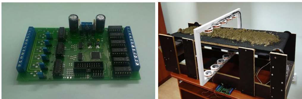
Рисунок 8 – Фото електронного пристрою для генерування сигналів випромінюючого блоку та імітаційного стенду для його наладки
