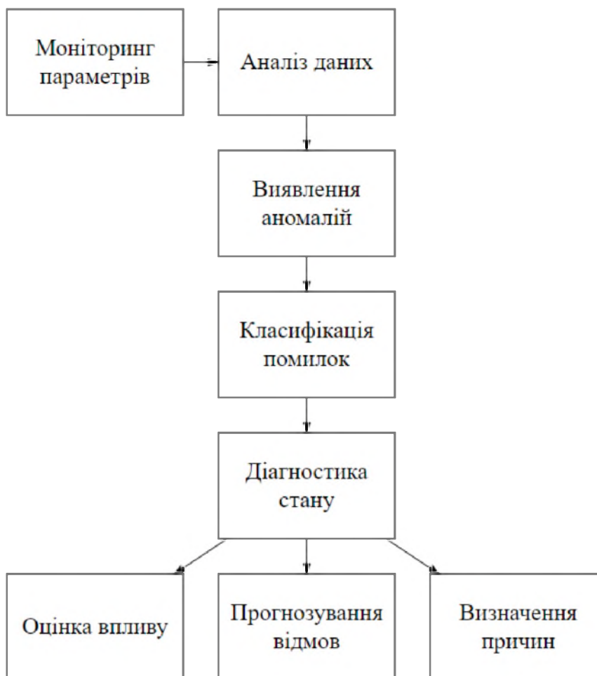
Рисунок 4.1 – Процеси, що реалізуються при здійсненні автоматичної діагностики роботи системи електропостачання
