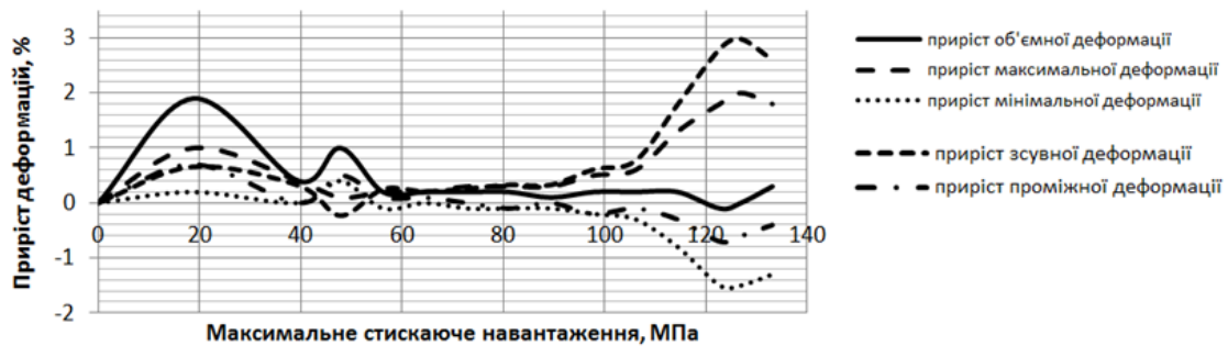
Рисунок 2 – Зміни приросту об'ємних, зсувних і лінійних деформацій в процесі навантаження зразка вугілля при \sigma_1 > \sigma_2 = \sigma_3 = 20 МПа від абсолютної величини максимального стискаючого напруження
