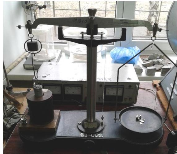
Рисунок 2 – Установка визначення питомої магнітної сприйнятливості гірських порід пондеромоторним методом ГУІ.
