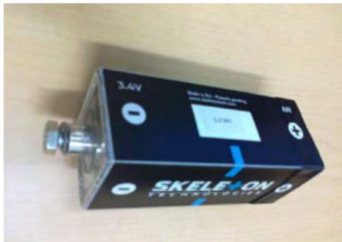
Рисунок 3.6 – Зовнішній вигляд суперконденсатора фірми “Skeleton Technologies” ємністю 3200 (Ф)
