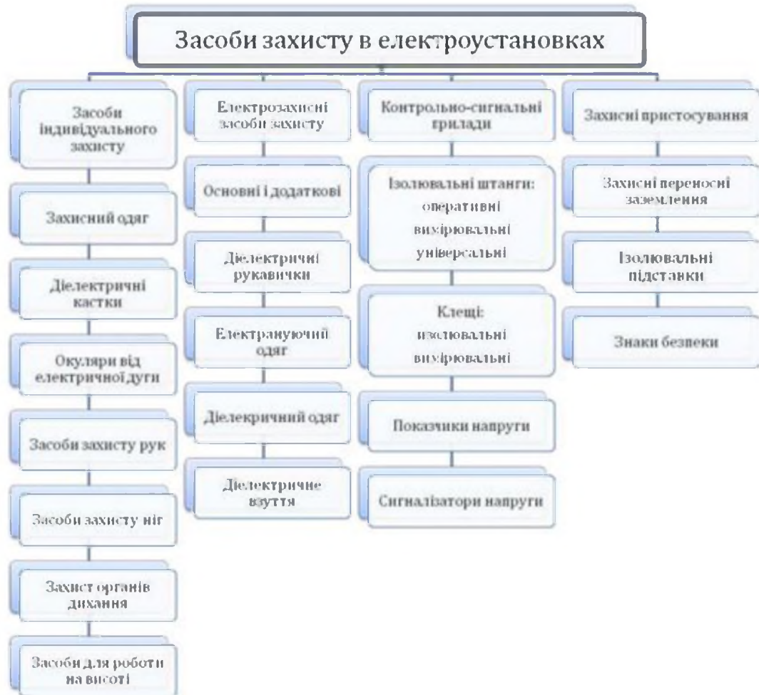
Рисунок 4.1 - Структурна схема засобів захисту, які використовують під час виконання робіт у електроустановках
