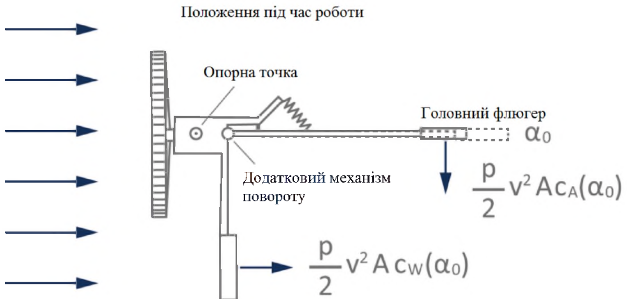
Рисунок 3.3 – Основні елементи вітрогенератору під час контролю потужності за допомогою повороту гондоли у нормальному режимі роботи
