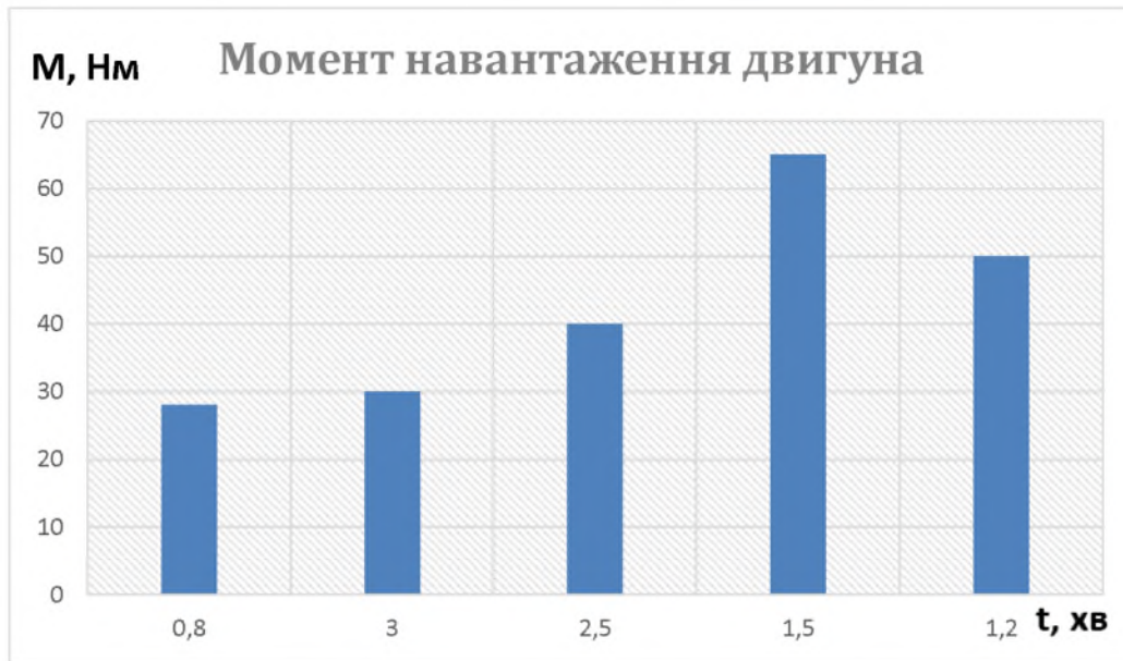
Рисунок 3.1 – Статична навантажувальна діаграма двигуна
