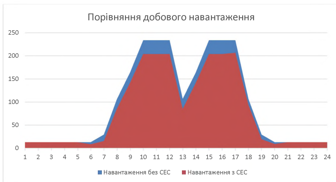
Рисунок 3.5 – Графік порівняння навантаження з встановленням в мережу сонячного джерела генерації
