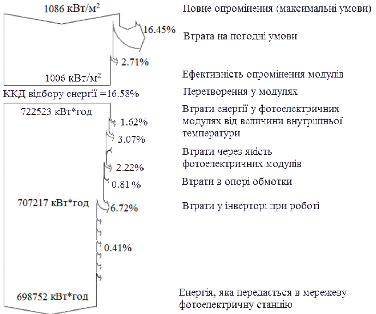
Рисунок 3.10 – Діаграма енергетична мережевої фотоелектричної станції
