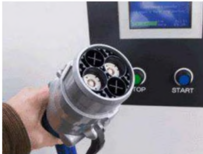
Рисунок 1.13 – Роз'єм Combined Charging System
