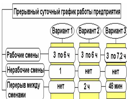
Рис.3.47. Режим проходческих работ при прерывном ходе функционирования производства
