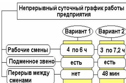
Рис.3.46. Режим проходческих работ при непрерывном ходе функционирования производства
