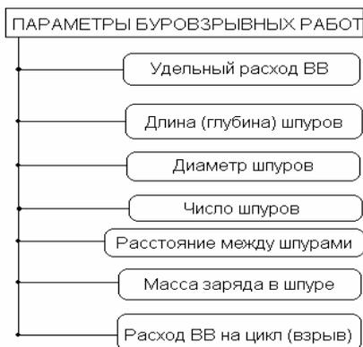
Рис.3.6. Параметры буровзрывных работ
