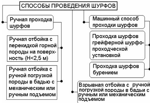
Рис.6.6. Способы проходки шурфов
