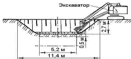
Рис. 7.8. Рытье котлована под оголовок ствола диаметром в свету
