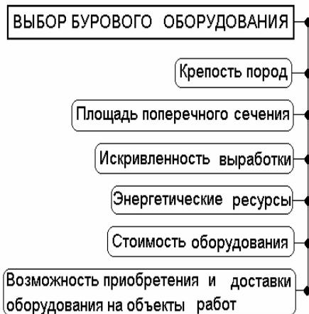
Рис.3.3. Факторы, определяющие выбор бурового оборудования
