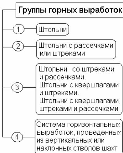
Рис.3.41. Группы выработок в зависимости от направления проведения и способов разведки
