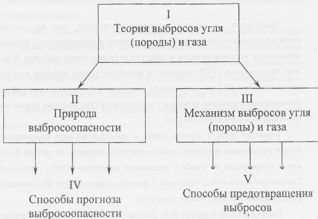
Рис. 2.1. Принципиальная методическая схема решения проблемы выбросов угля (породы) и газа
