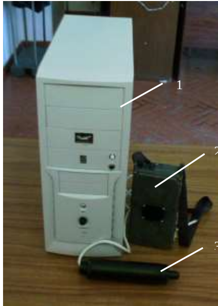
Рис. 3.2 – Зовнішній вигляд апаратури АПСС-1: 1 — наземний блок; 2 — пристрій телефонного зв'язку; 3 — сейсмоприймач
