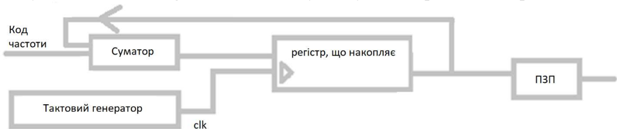
Рисунок 1 – Структурна схема цифрового генератора прямого синтезу з акумулятором фази
