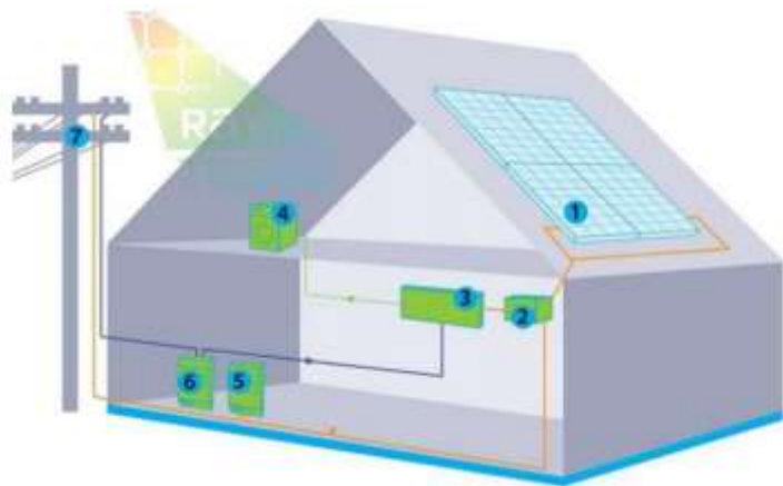
Рисунок 1. Система on-grid для продажу електроенергії в мережу:
