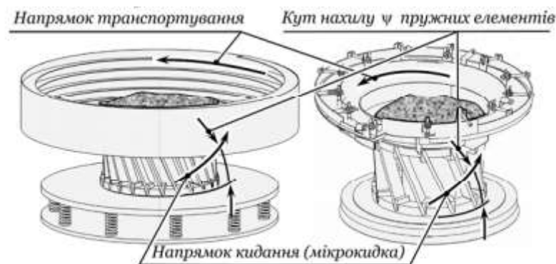
Рисунок 1. Вібраційні бункерні живильники з циліндричною та конусоподібною чашами
