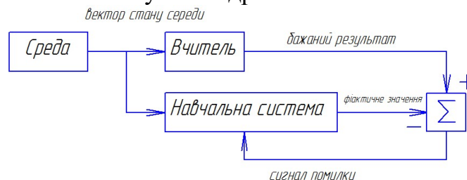
Рисунок 2 – Функціональна схема навчання з вчителем.
