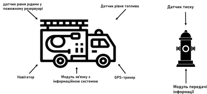
Рисунок 2 -моніторинг пожежної машини та гідранту
