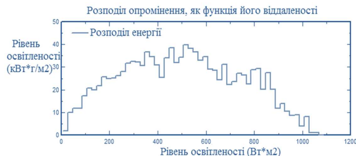
Рисунок 1 – Графік розподілу рівня вихідної енергії фотоелектричних панелей, як функція їх зовнішнього опромінювання (освітленості)
