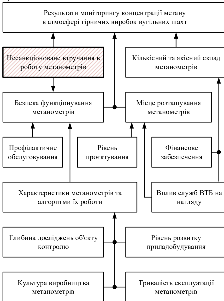
Рисунок 2. Структура впливу базових організаційних й технічних факторів на результати вимірювання концентрації метану в атмосфері вугільних шахт
