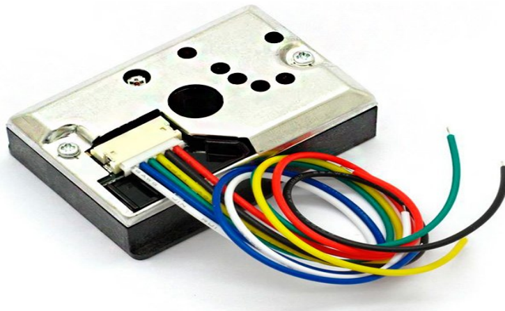
Рисунок 2.5 – зовнішній вигляд датчика пилу GP2Y1010AU0F
